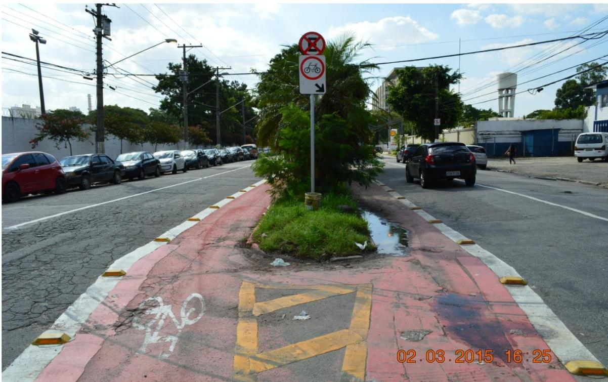
Vista da ciclofaixa da Av. Torres de Oliveira, proximidade do no 435, com empoçamento de água, obstruído por ramagens de árvores, depressões e com pintura desgastada.
